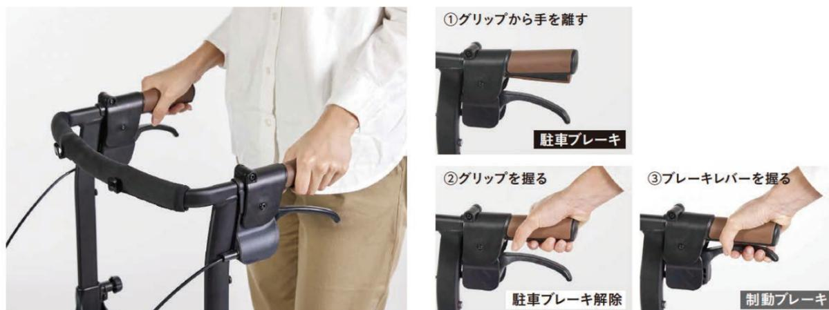
グリップから手を離すだけで駐車ブレーキがかかります(①)。グリップを握ると駐車ブレーキが解除され歩行可能となります(②)。その状態でブレーキレバーを握ると制動ブレーキが作動します(③)。
