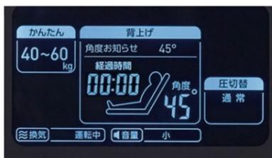
背上げ時の角度表示は、セミファウラー位の 15 度から 5 度刻みで液晶画面に表示。背上げ経過時間も表示されるので、経管栄養等のケア時間管理にも使えます。
